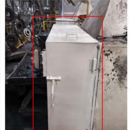
ติดตั้งผนังกันเสียงที่จุดเขานงาน casting cooler B2
